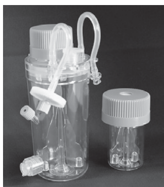
図1. iPS細胞の浮遊攪拌培養に適したシングルユースバイオリアクター。液量100 mL (左)と30 mL (右)。
