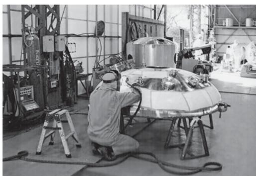
図2. 上：タンク上鏡の加工，下：タンク上鏡の溶接
