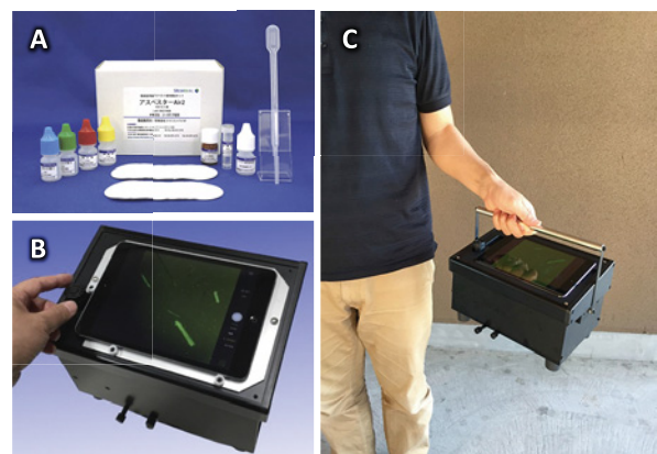
図2. 蛍光試薬セット(A)と携帯型蛍光顕微鏡(B, C)。携帯型蛍光顕微鏡のZ軸の調整はiPad ® 横のつまみで調整する。X、Y軸の調整はボックス下のつまみで調整する。画面上の倍率は約300倍で、iPad ® の画面の拡大により約1000倍まで拡大できる。携帯型蛍光顕微鏡を利用している様子は、シリコンバイオ社のホームページで公開されている( http://www.siliconbio.co.jp )。平成28年度環境賞環境大臣賞受賞。
