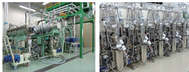
図2. バイオマス変換技術実証ベンチプラント内設備の例 (左: 連続前処理装置, 右: 並行複発酵装置)
