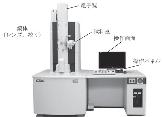
図3. 透過電子顕微鏡の外観(日立HT7700形TEM)
