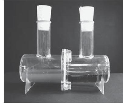
図5. 二槽式透析培養器のプラスチック製品。
