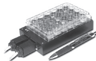
マイクロウェル培養モニタリングシステム SDR (センサーディッシュリーダー)
