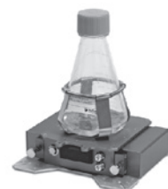
振とう培養モニタリングシステム SFR vario (センサーフラスコリーダー)
